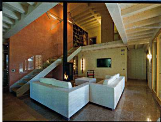
Il salone a doppia altezza della casa dove il lucernario apribile e schermato diventa un camino di ventilazione
